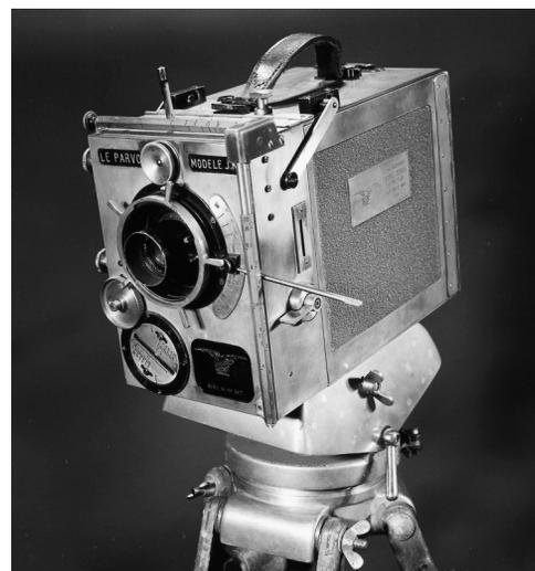
**Le Parvo JK auf einem Originalstativ aus der Zeit, unter der hinteren Haube verbirgt sich bei diesem Debrie-Stativ ein freilaufender Kreisel für Horizontalschwenks!**
