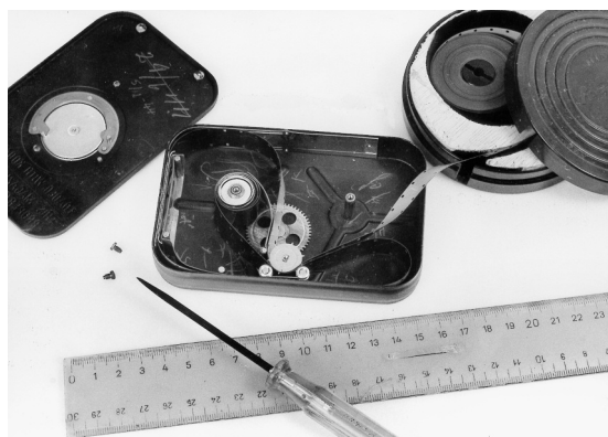
Eine Kodak/Bell & Howell-Kassette mit eingelegtem Film und einer modifizierten Filmbüchse mit lichtdichtem Auslass.
