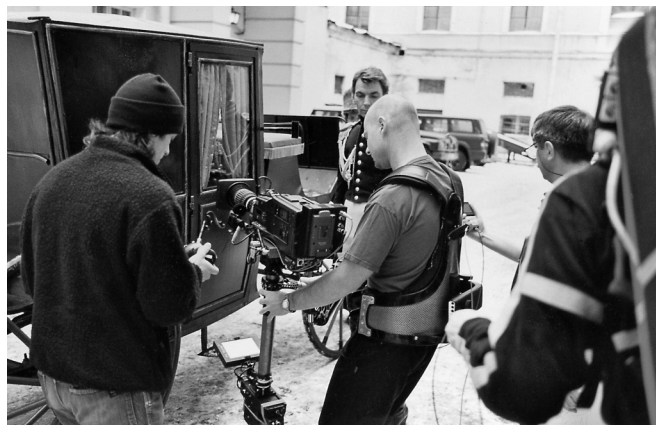
Tilman Büttner bei einer Aussenszene; deutlich zu sehen die spezielle Weste mit der Befestigung des Steadicam-Arms am Rücken
