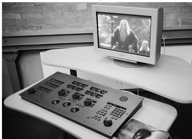
Das 5D-Colossus-Farbkorrektur-system: Monitor und Korrektur-konsole mit Trackballs
