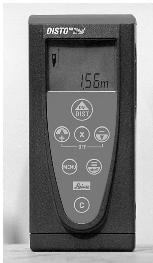
Disto lite: Das Symbol links oben in der Ecke signalisiert, dass die Anlagekante derzeit die Rückseite des Geräts ist; die Entfernungsanzeige erfolgt hier in Metern und Zentimetern
