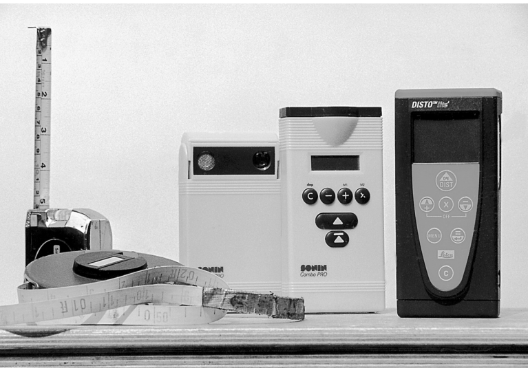
Messwerkzeuge: Massbänder, Sonin Combo Pro ; Disto light
