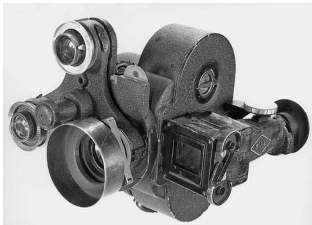
Eine solche Suchertür wurde auch mit einem fest integriertem Entfernungsmesser geliefert. Den komfortabelsten Sucher zeigt die Abbildung 1. Dieser Newton-Sucher ist mit drei einschwenkbaren Masken und einem Einschub für zusätzliche Formate ausgerüstet und lässt durch das Rändelrad an der Oberseite einen ziemlich genauen Parallaxenausgleich zu. Deutlich sichtbar ist der Einschub für Gelatinefilter hinter dem ‚Spider‘ (was übrigens ‚Spinne‘ bedeutet).
